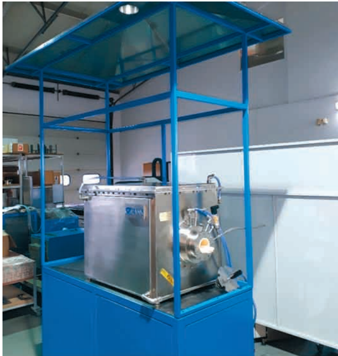
Rysunek 16. Wysokotemperaturowy piec laboratoryjny do badań procesu redukcji tlenków żelaza w fazie ciekłej
